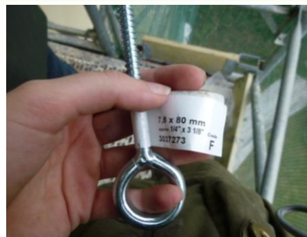
Abbildung 9: Rundhaken zur temporären Befestigung der Pflanze (Quelle: Schaufler 2011)
